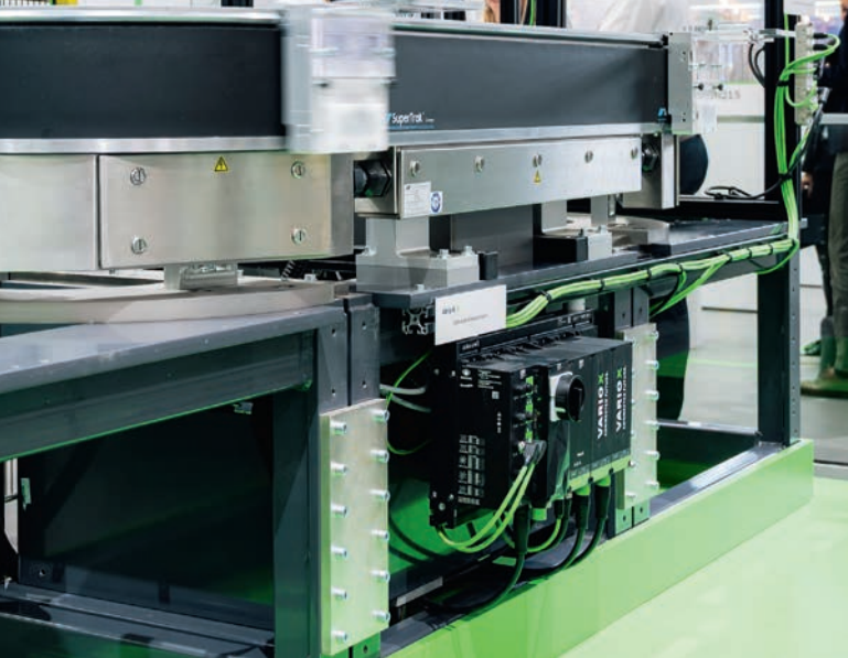
Im Fokus des Messeauftritts stand das Vario-X System, das eine modulare und flexible Maschinenarchitektur mit dezentraler Intelligenz ermöglichen soll.
