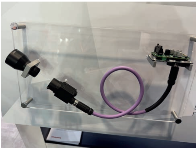
► HySpeedVision von Rosenberger ist eine Konnektivitätslösung die Bilddaten mit bis zu 12Gbps und über 12m überträgt.
