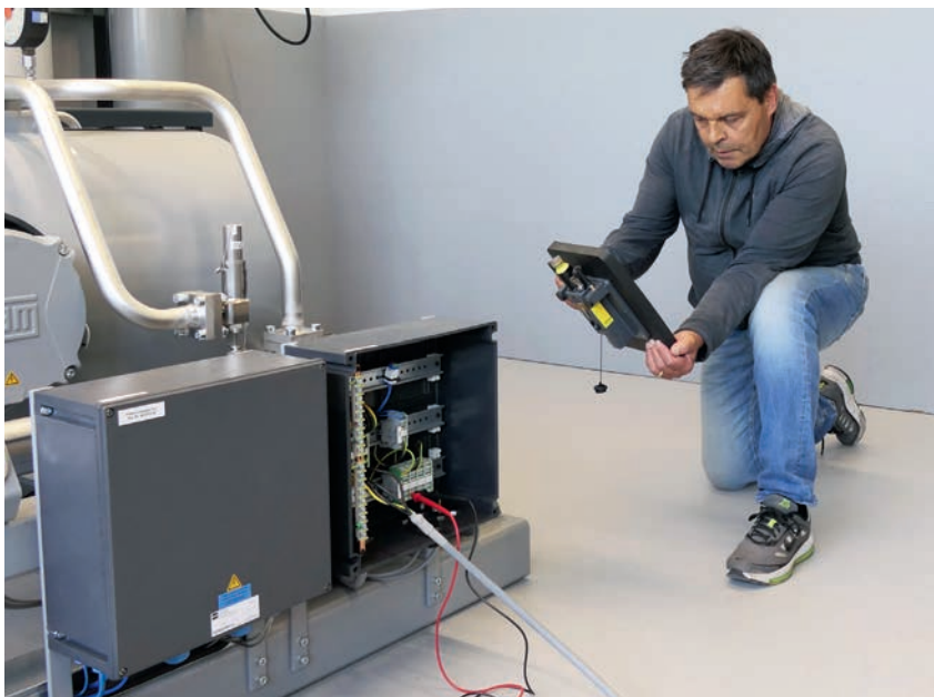
► Kurt Zeller, Verantwortlicher Montageendprüfung, schätzt die Bewegungsfreiheit mit dem mobilen Wireless-Bedienpanel inklusive Safety.
