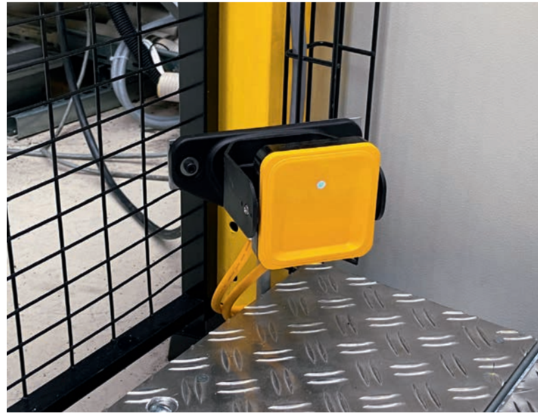
► Die sichere Radarlösung PSEnradar von Pilz bei Weidplas: im Bild einer von drei Radarsensoren. Mit seiner dreidimensionalen Bereichserfassung detektiert er Bewegungen im Schutzraum.
