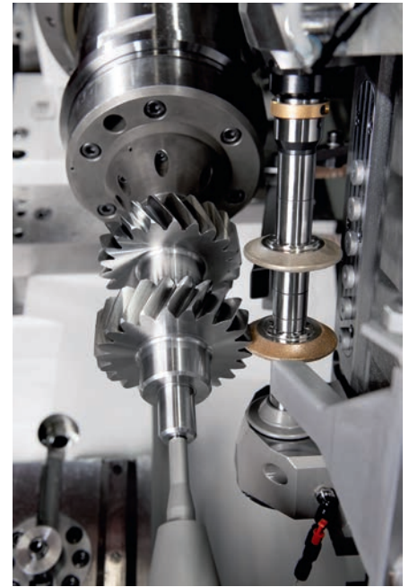
Auf den Schleifspindeln der VX-Maschinen lassen sich zeitgleich mehrere Schleifscheiben einsetzen.
