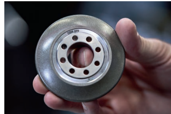
Mit CBN pro, den neuen Werkzeugen von Kapp Niles, sind Oberflächengüten von Ra < 0,2\mu m am Werkstück erreichbar.
