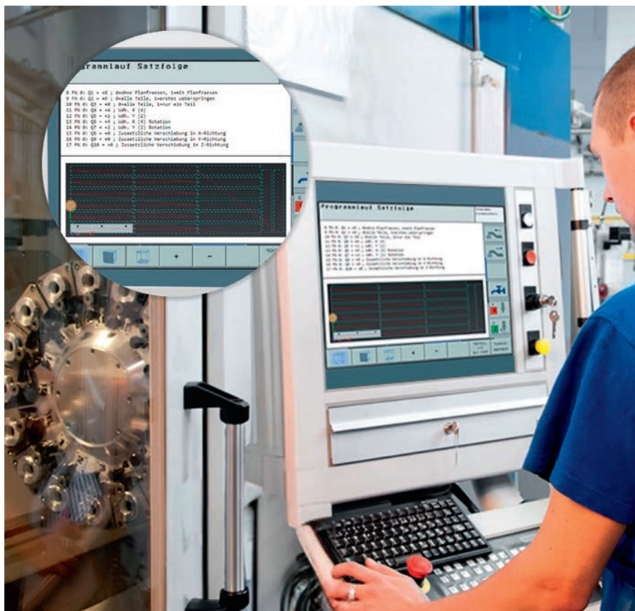
Steuerparameter Heidenhain am Anfang der NC-Datei zum Steuern der Fertigung durch den Maschinenbediener und Bauteil mit Wiederholbearbeitungen mit zwei Feldern 3x5 und 2x1.
