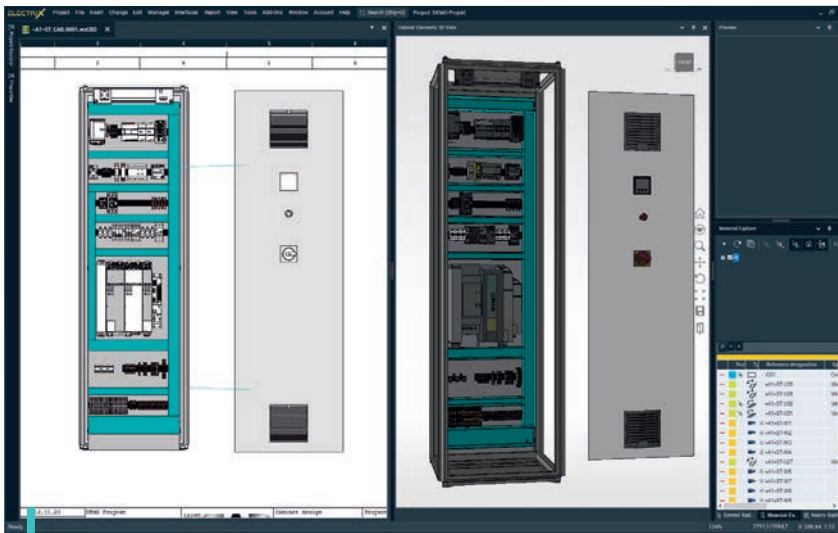
Schaltschrankaufbau mit Electrix AI
