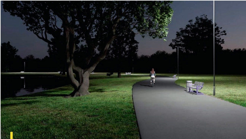
Auch im Aussenbereich detektiert der SensorX das Umfeld durch Machine-Vision-Bildverarbeitung: Die Radfahrerin wird erkannt, das Licht wird heller.
