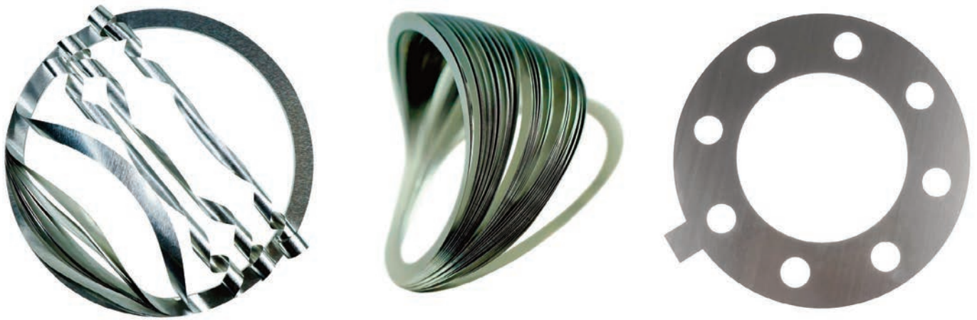
▲ Ein Trio für viele Zwecke: Je nach Variante lassen sich die randverschweißten oder laminierten Passscheiben der Typen Lamivario (links) und Laminum (Mitte) bis auf 5,0 Mikrometer genau abziehen oder abschälen. Massive Folien und Passbleche führt das Unternehmen unter der Bezeichnung Lamisol (rechts).
