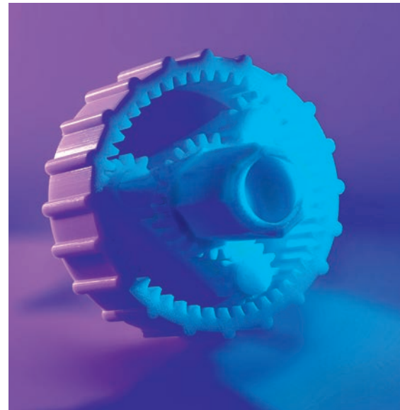
▲ Selbst komplexe Geometrien und funktionsfähige Getriebe lassen sich per 3D-Druck herstellen.
