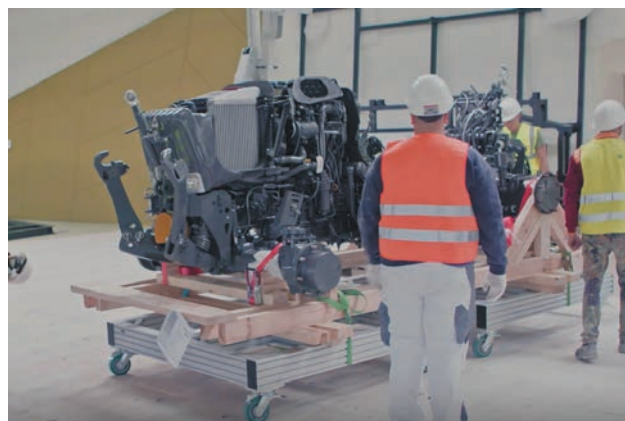
▲ Dank der geringen Bauhöhe der Transportwagen wird die maximale Transporthöhe nicht überschritten.
