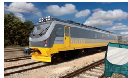
Vollständig 3D-gedruckte Frontverkleidung eines Schienenfahrzeugs.
