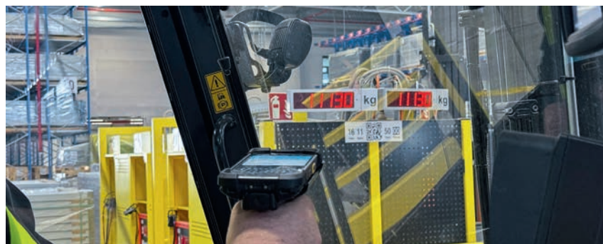
Das Lagerverwaltungssystem verteilt Packstücke nach Größe, Gewicht und Lagerzone. Das Gewicht wird bei der Einlagerung über eine Überfahrwaage erfasst.
