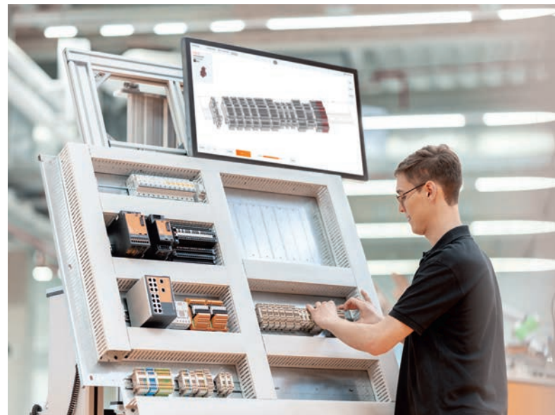
Bild 2 | Effiziente Klemmenleisten-Montage in der Produktion mit Hilfe des Online Configurators.
