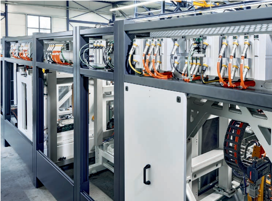
Bild 2 | Das MX-System von Beckhoff zur schaltschranklosen Automatisierung wird dezentral direkt an der Maschine montiert.
