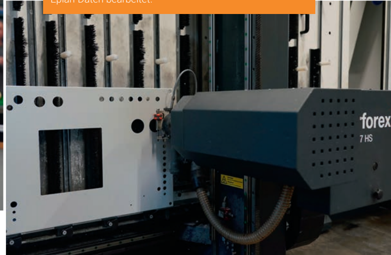
Bild 3 | Mit einer Perforex von Rittal Automation Systems werden Schränke wie auch Stromschienen auf Basis der Eplan-Daten bearbeitet.
