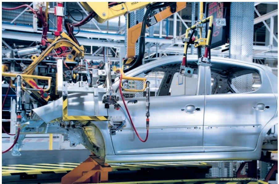
Mehrere PKW-Hersteller setzen an ihren Montagelinien Hubsysteme von Leantechnik ein.
