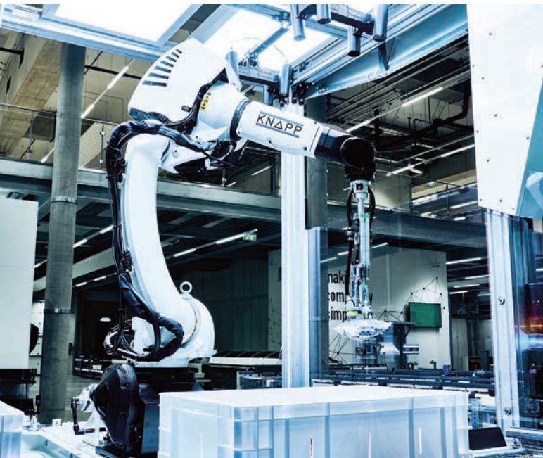
Die neueste Generation des mit künstlicher Intelligenz ausgestatteten Roboters Pick-it-Easy Robot von Knapp übernimmt unter anderem die vollautomatische Befüllung von Sorter-Taschen.
