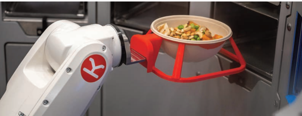
In der Semblr-Lösung sorgt ein KR Agilus von Kuka für gefüllte Schüsseln.
