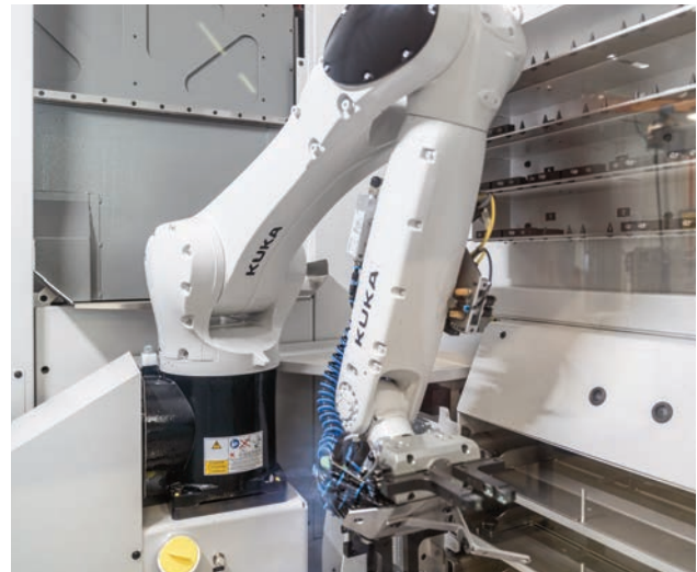
Acht Greiferpaare stehen dem Roboter im Greiferbahnhof (oben rechts im Bild) zur Verfügung.
