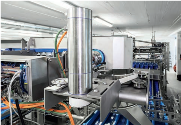
Der Spezialgreifer erfasst mit Vakuumsaugtechnik 56 Würste mit einem Hub – den Inhalt von vier Packeinheiten.
