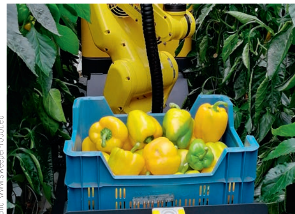
Der Sweet Pepper Robot erkennt und erntet reife Paprika mit Hilfe eines form- und farbbasierten Detektionsalgorithmus, der auf MVTec Halcon basiert. Seite 58
