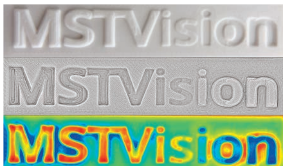
Bild 1 | Mit der Photometric Stereo Linienleuchte MST-PSL sind Bestrahlungsstärken von 2kW/m² bei einem Arbeitsabstand von 100mm problemlos möglich. Bild eines Musters (3D-Druck), Kurvenbild, Höhenkarte (v.o.n.u.)
