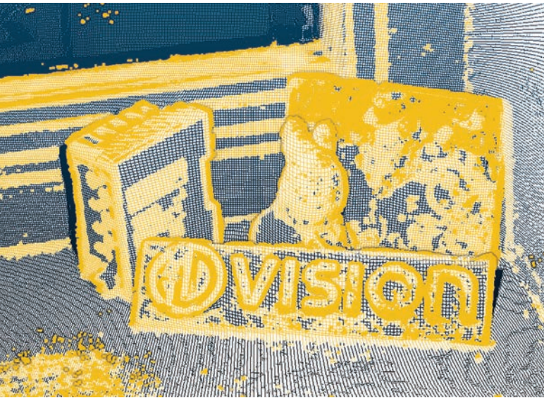
Bild 2 | Die Lösung von HD Vision erzeugt 3D-Punkte eher an Objektmerkmalen wie Kanten, also dort, wo es für die 3D-Erkennung wichtig ist.
