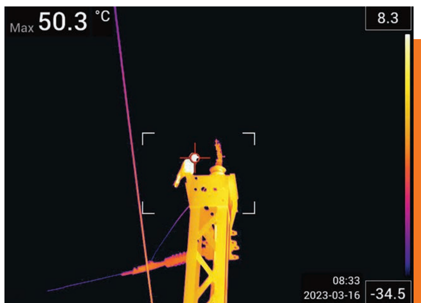
Bild 2 | Höchste Präzision ist bei der Arbeit mit dem Teleobjektiv notwendig. Schließlich möchte man die Temperatur des Bauteils, nicht die des darauf sitzenden Vogels erfassen.
