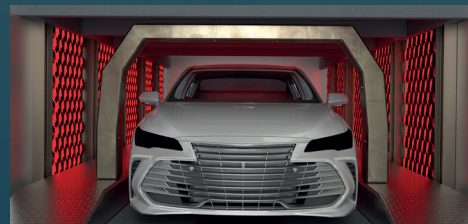
Temperaturmessung beim Lackieren von Karosserien
