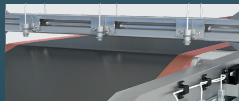
Temperaturmessung in Beschichtungsprozessen
